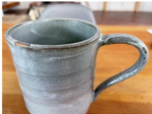
Ejemplo de descascarillado.
